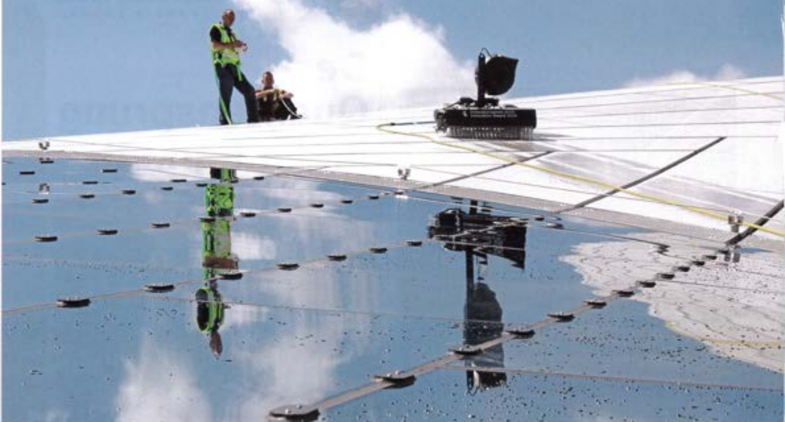
Die Standardausführung des HyCleaner black Solar wurde am Hauptbahnhof Arnheim getestet und anschließend modifiziert.
