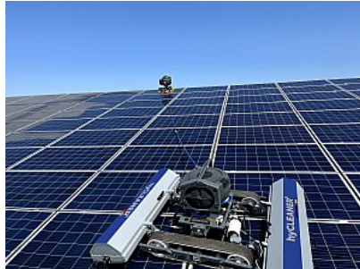
Um die Leistungsfähigkeit einer PV-Anlage zu erhöhen, sollte sie regelmäßig gereinigt werden © hyCLEANER GmbH & Co. KG
