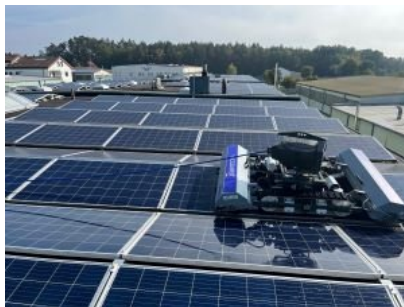
Durch Verschmutzungen verringert sich die Performance von Solaranlagen beträchtlich – Abhilfe schaffen spezielle PV-Reinigungsroboter © hyCLEANER GmbH & Co. KG
